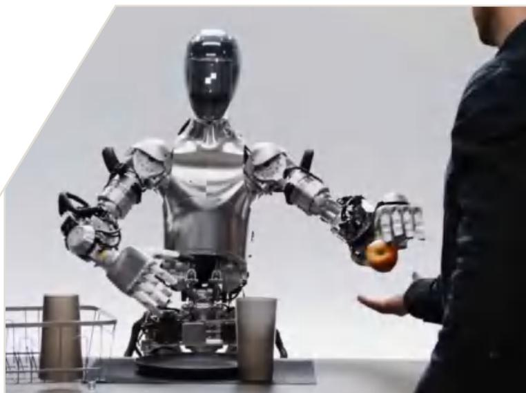
该机器人得益于NVIDIA处理器所带来的CPU和GPU容量翻三倍的增强计算能力，能够实现复杂的AI推理和自主运行。
